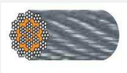
Vue en coupe transversale du câble antigiratoire 19 torons de 7 fils
